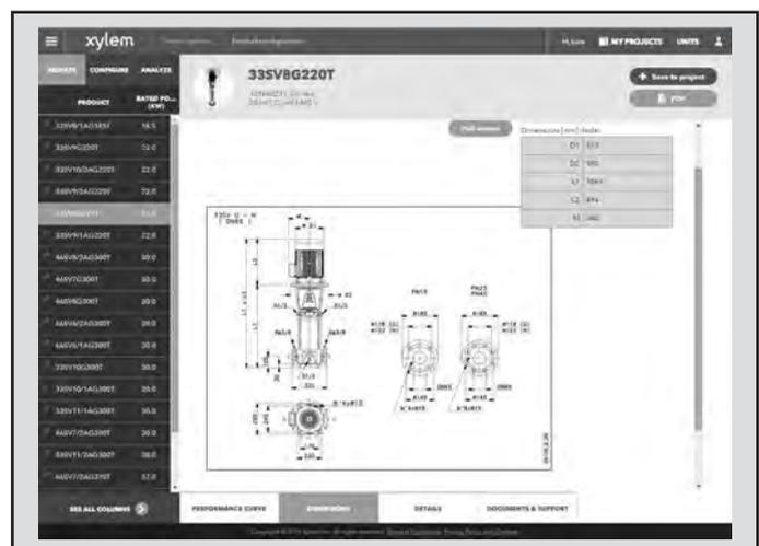
Отображаемые на экране габаритные чертежи можно скачать в формате .dxf
