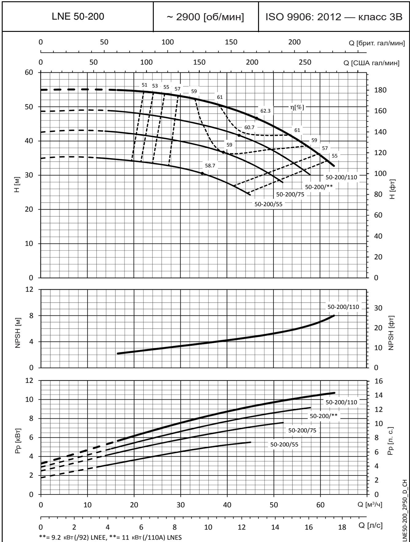
Значения NPSH (допустимой высоты всасывания) замерены в лабораторных условиях; для практических нужд рекомендуем увеличить эти значения на 0,5 м. Эти показатели действительны для жидкостей плотностью  $\rho = 1,0 \text{ кг/дм}^3$  с кинематической вязкостью  $\nu = 1 \text{ мм}^2/\text{с}$ .
