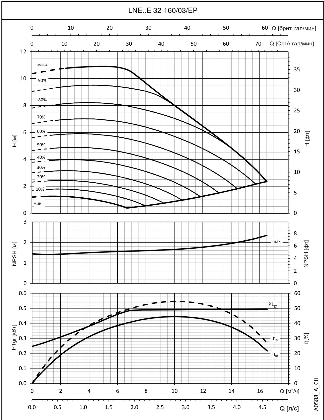
Показатели производительности действительны для жидкости плотностью  $\rho = 1,0 \text{ кг/дм}^3$  и с кинематической вязкостью  $\nu = 1 \text{ мм}^2/\text{с}$ .
