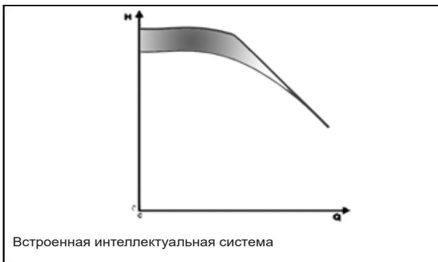
**Регулировка:** возможна как при постоянном давлении, так и согласно кривой характеристики системы, на основании предпочтений заказчика. Другой вариант — согласно внешнему сигналу или с предварительно заданной скоростью.
